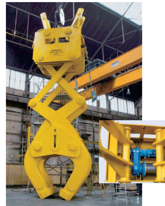
スチールスラブを搬送するグリッパーに装備された MPW オープンウインチ
