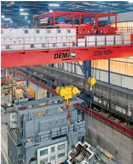
250 t MPW ツインホイストクラブ +100 t MPW オープンウインチ付プロセスクレーン
