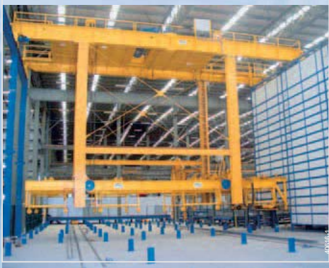
250 t MPW ツインホイストクラブ +100 t MPW オープンウインチ付プロセスクレーン
