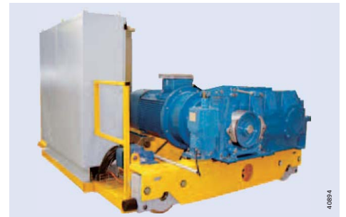
特殊電気開閉盤付き 32 t MPWクラブ
