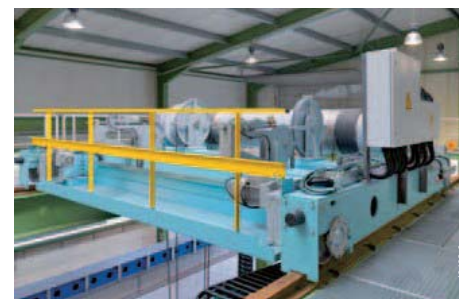
ハンドリング用 telescopic (伸縮) グリッパー付きフル装備の MPW クラブ
