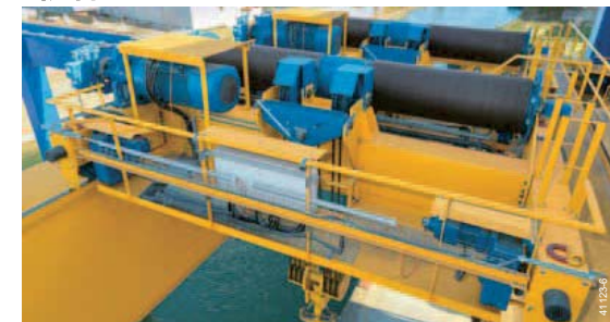
港湾で使用されている屋外使用防水設備付き 2 x 1 2 5 t MPWクラブ
